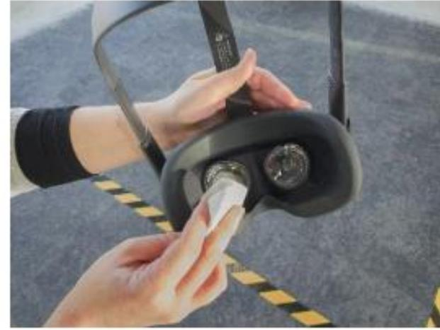
Décontaminer les optiques avec de l'alcool à 70°, de façon circulaire, du centre vers le bord.
